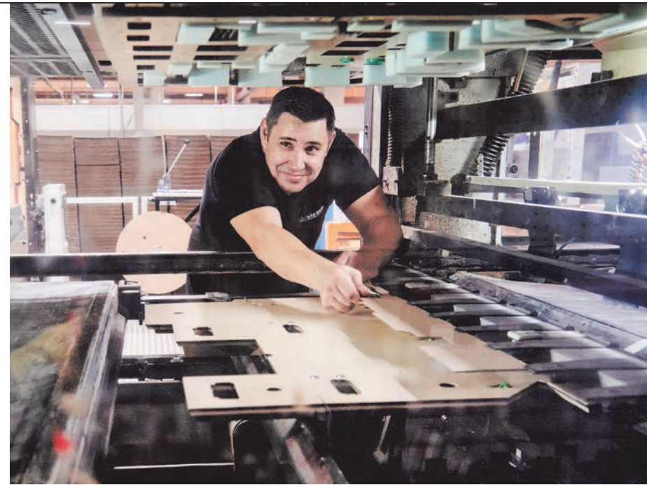
Korrekte Justierung: Maschinenführer Josef Thomas richtet einen Wellpappenkarton aus. Löcher, Schlitzte oder Rillungen werden hier auf den Millimeter genau in Karton eingestanz.
