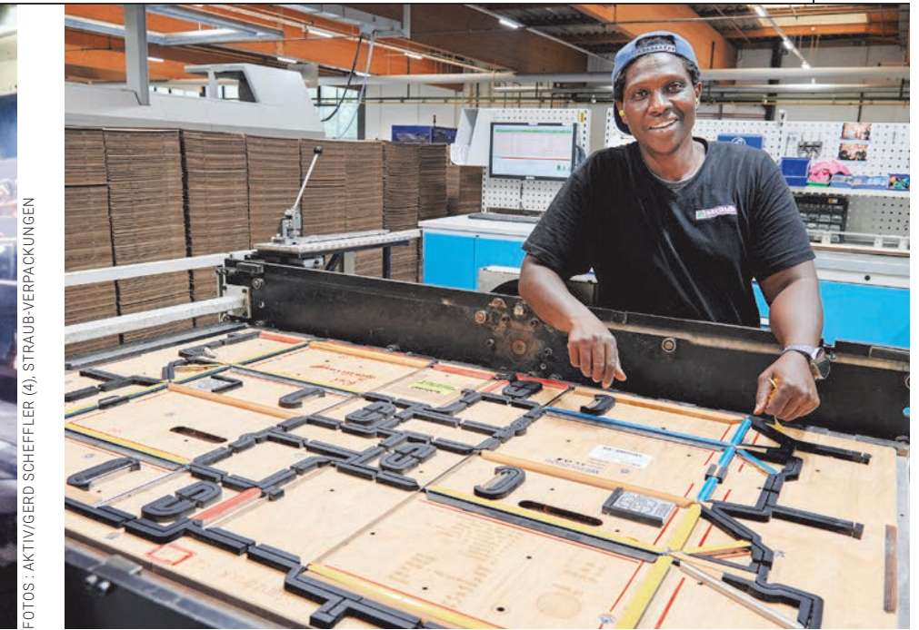
Durchdacht: Produktionsmitarbeiter Sainey Kanyi zeigt ein Stanzwerkzeug für einen Karton mit Automatikboden. Der schiebt sich korrekt zusammen, sobald der Karton aufgestellt wird.
