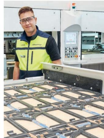
Er kennt Maschinen und Abläufe: Jan Schneider, hier an einem Stanzwerkzeug, das Verpackungen aus einem Wellpappbogen ausstanzt.
