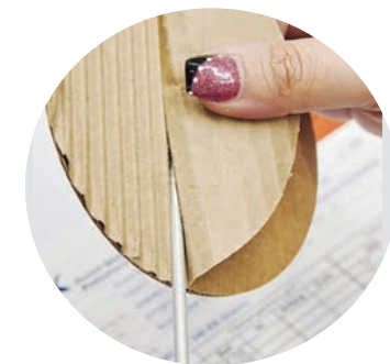
Qualitätsprüfung im eigenen Labor: Hier wird die Klebung und Haftung der Wellen kontrolliert.
