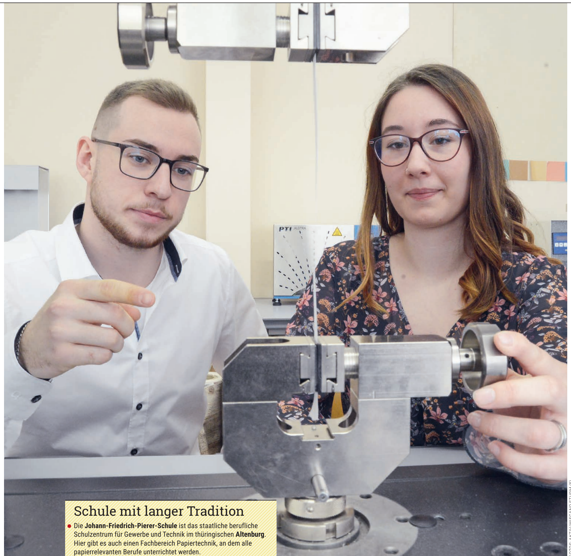
Aufgestiegen: Lukas Klimpel und Michelle Käppler haben sich zu Papiertechnikern weitergebildet. Hier sieht man die beiden an einem Prüfgerät für die Zugfestigkeit von Papier.
