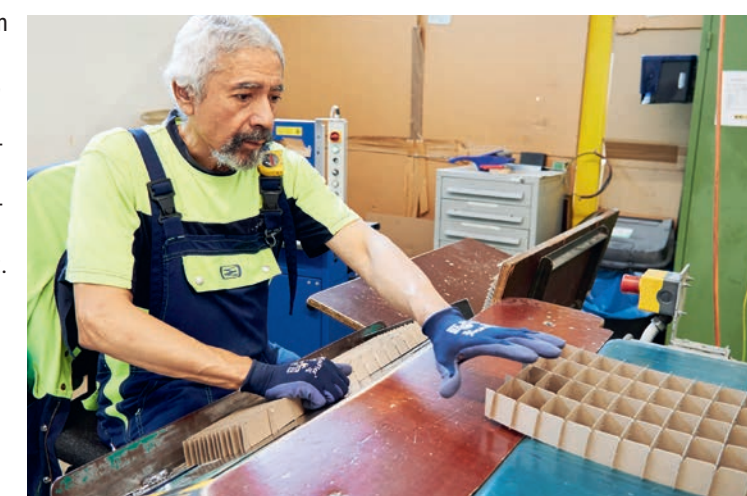
Bewährte Kräfte und schon lange im Betrieb: Die Maschinenhelfer in der Produktion – zum Beispiel Natascha Gaber, hier beim Einlegen der gestanzten Einzelteile, und Julio Mandiche, der fertige Gefache bündelt.
