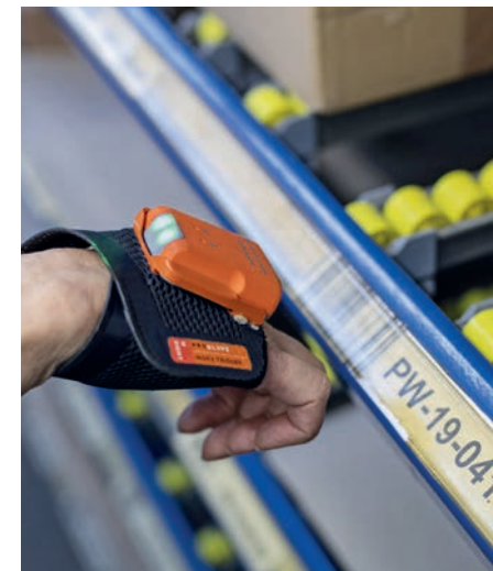
Digitale Unterstützung: Bei der Kommissionierung hilft ein Scanner am Handgelenk.
