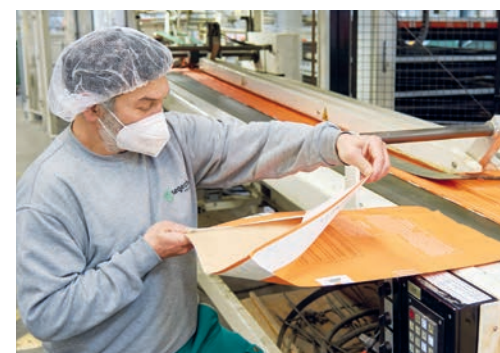
Kontrolle: Ahmet Yildirim prüft die Klebung eines Papiersacks in der laufenden Produktion.
