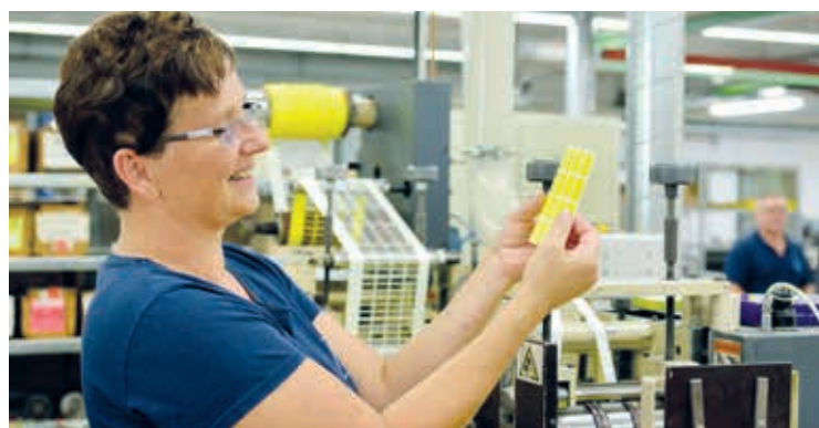
Präzise: Susanne Berndt bedient eine Maschine, die Etiketten ausstanzt – etwa knallbunte Aufkleber.
