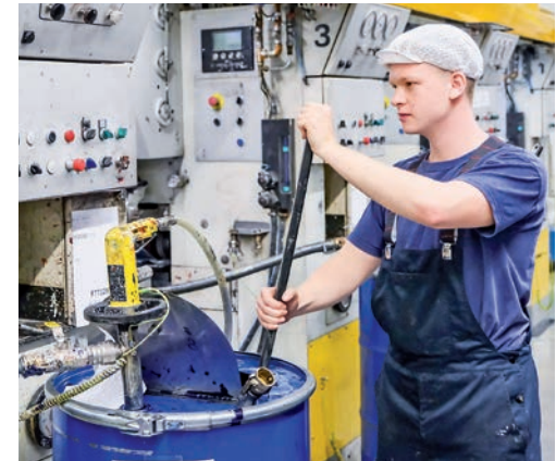
Die Mischung macht's: Vor dem Befüllen der Maschine wird die Farbe noch einmal aufgerührt.
