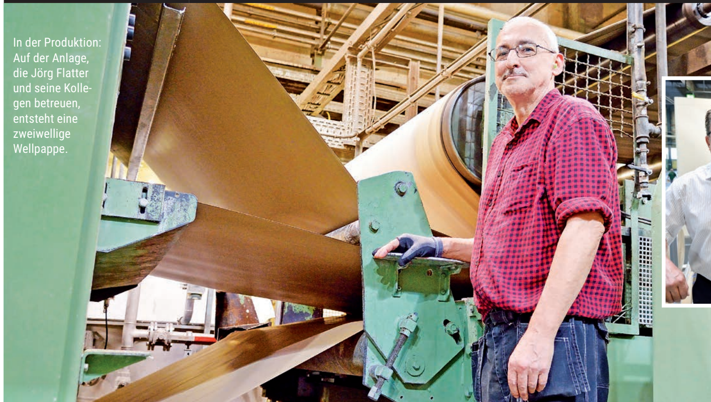
Stolz auf die Verbesserungen: Detlev Wessel an einer neuen Maschine, die einseitige Wellpappe herstellt.
