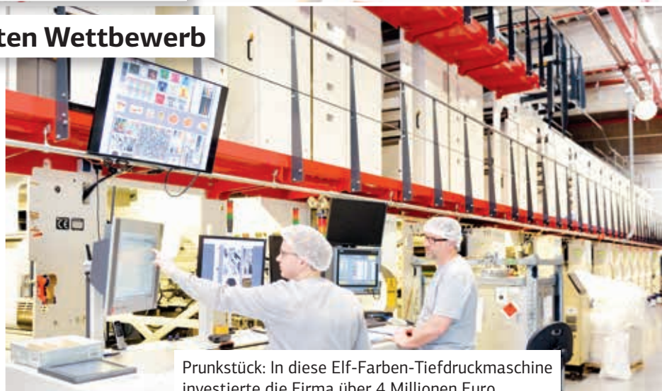
Spezialität: Maschinenführer Frank Frauendorf an einer Anlage, die Kaubonbon-Papier mit Wachs beschichtet.
