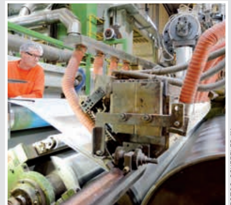
Vorsicht, heiß! Hier wird flüssiger Kunststoff auf die Papierbahn aufgebracht.
