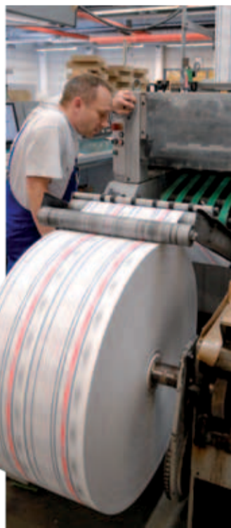
Einzelstücke: Steffen Trinks an einer Druckmaschine, die jedem Formular auf der Rolle eine andere Nummer gibt.
