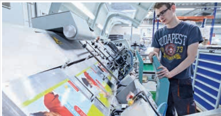
Kontrolle: Sebastian Polster überwacht eine Spiralbindung.
