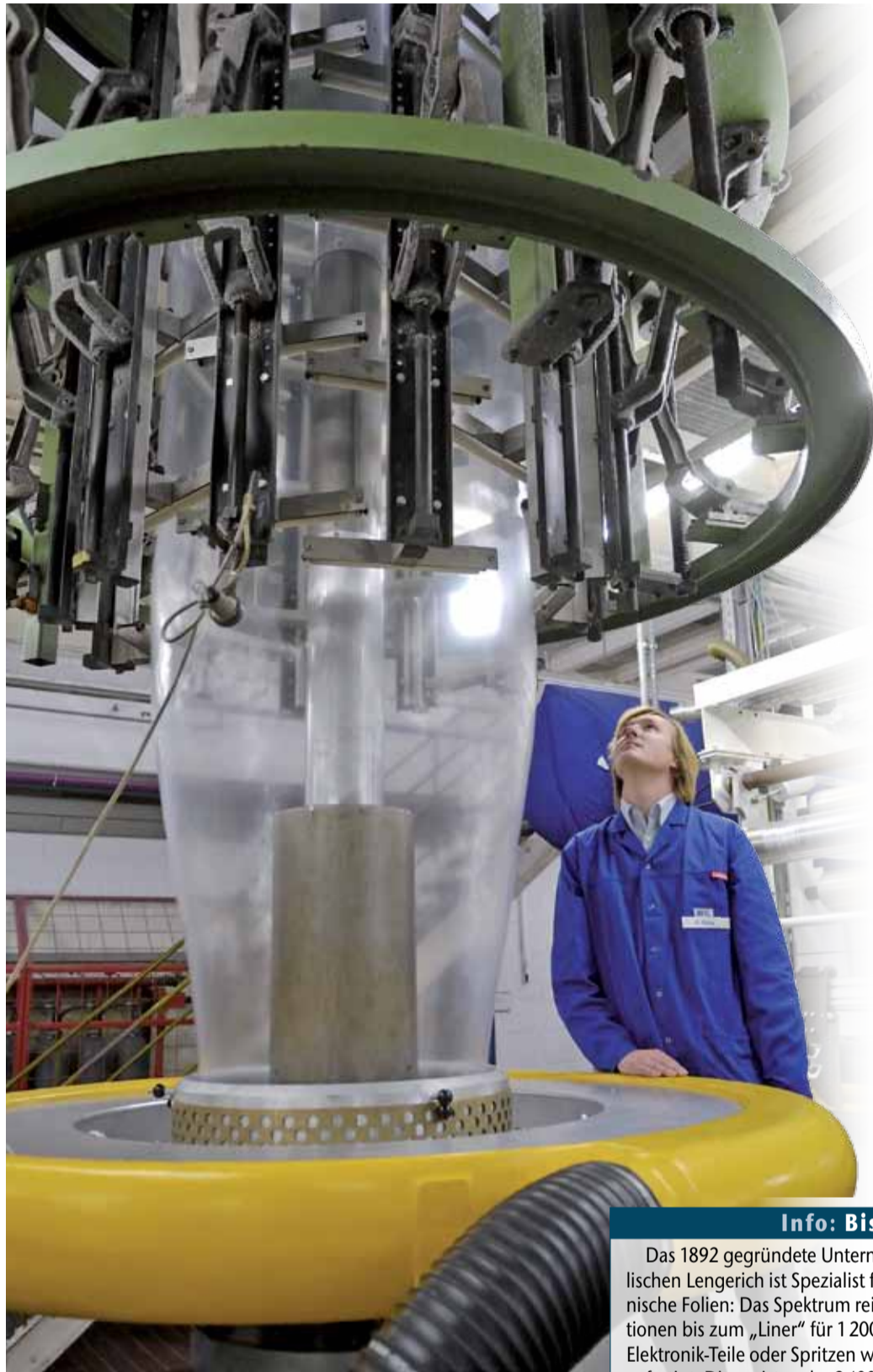
Cooler Sach: Ingenieur Kristoffer Rahe sieht der Folie nach, die zu einem hohen Schlauch aufgeblasen wird. Der neue, gelbe Kühlteller senkt den Energieverbrauch deutlich. Fotos: Scheffler (2)
