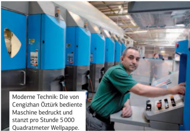
Moderne Technik: Die von Cengizhan Öztürk bediente Maschine bedruckt und stanzt pro Stunde 5 000 Quadratmeter Wellpappe.
