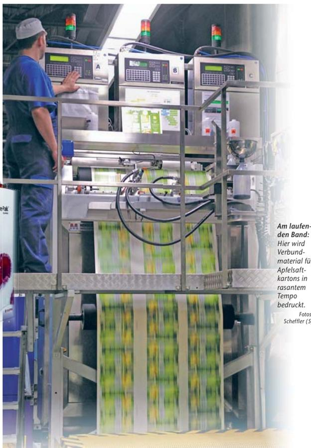
**Am laufenden Band:** Hier wird Verbundmaterial für Apfelsaftkartons in rasendem Tempo bedruckt.
