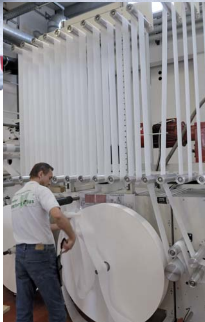
Qualitätskontrolle: Kilometerlange Vlies-Bahnen werden sorgfältig geprüft, ehe sie weiterverarbeitet werden. Foto: Scheffler (3)
