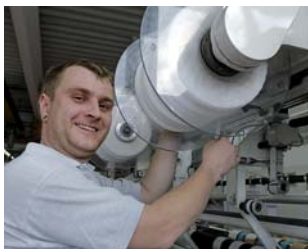
Rocco Stobbe im Einsatz: Diese Maschine schneidet am laufenden Band Vlies zu.
