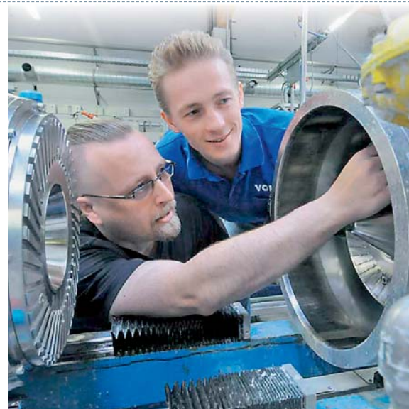
Einblick: Ausbilder Achim Vogt (links) erklärt dem Studenten Johannes Kaiser den Refiner, in dem Faserstoffe gemahlen werden.
