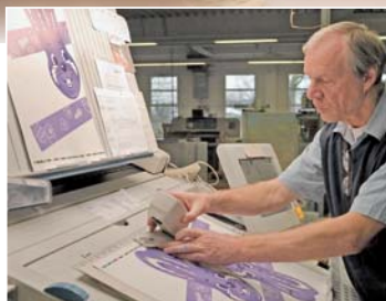
Ostern in Sicht: Matthias Erkens prüft mit einem Densitometer die Farbdichte.
