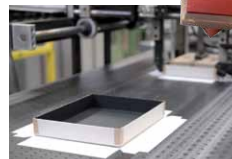
Am laufenden Band: Jeder Karton erhält vollautomatisch den veredelten Bezug.
