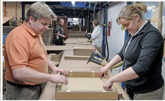
Gekonnte Konfektionierung: Anne Freudenberg und Adam Pieruszka kleben Wellpappe-Polster in einen Karton.
